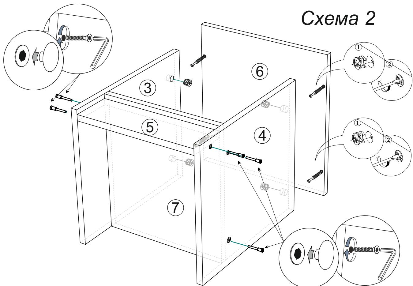
4. Чтобы установить задние стенки (детали №1), необходимо собранную конструкцию перевернуть лицевой стороной вниз. Замерить, с помощью рулетки, и уловнять диагонали ( $a=b$ ). Наложить заднюю стенку. Аккуратно, не нарушая диагоналей, прибить ЛДВП гвоздями, шагом 130-150 мм., как показано на схеме 3
