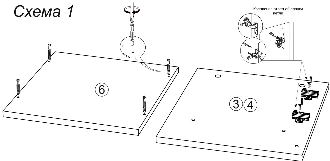
3. Соедините евровинтами боковины №3 и №4 с цоколем №5, вязкой №7. Закрепите крышку №6. Для этого затяните эксцентриковые стяжки на боковинах, как показано на схеме 2.
